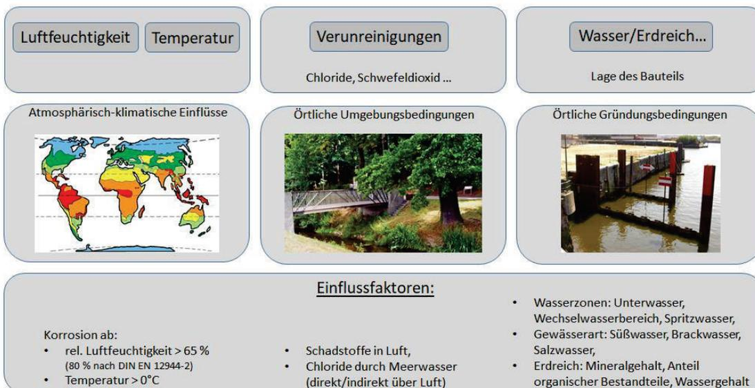
**Korrosionsgeschwindigkeit:** mit steigender Luftfeuchtigkeit, zunehmender Verunreinigung der Luft, Kondenswasserbildung
