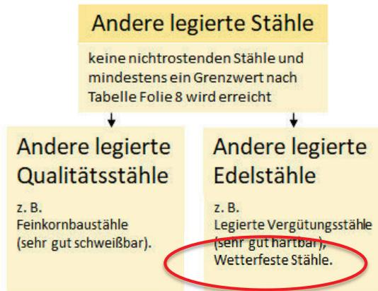
DIN EN 10025-5: „Stahl, dem eine bestimmte Anzahl von **Legierungselementen wie Phosphor, Kupfer, Chrom, Nickel, Molybdän** usw. zugesetzt wurde, um den **Widerstand gegen atmosphärische Korrosion zu erhöhen,...**“
